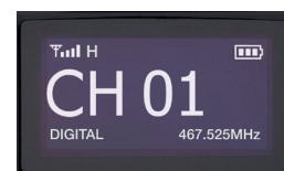
Das informative Display beim UHF-Modell zeigt sowohl die Kanalnummer als auch die Frequenz an
